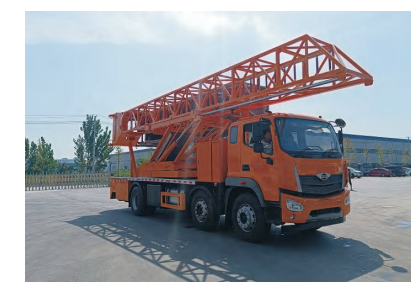
福田桁架桥梁检测车
