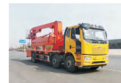
解放臂架桥梁检测车
