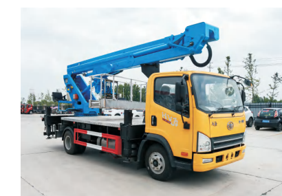
解放臂架桥梁检测车
