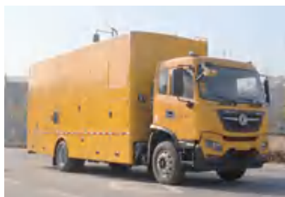
东风天锦100~200KW电源车
