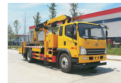
解放臂架桥梁检测车
